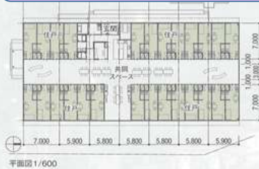
(写真8) 周囲に自然があふれる要介護者向けサ高住 校舎の北側に位置するサ高住「ひろばの家・那須2」。屋内プールを改修した。延べ面積は798㎡で、鉄骨造の平屋。すぐ近くに森があり、各部屋からは四季折々の景色を眺めることができる。
